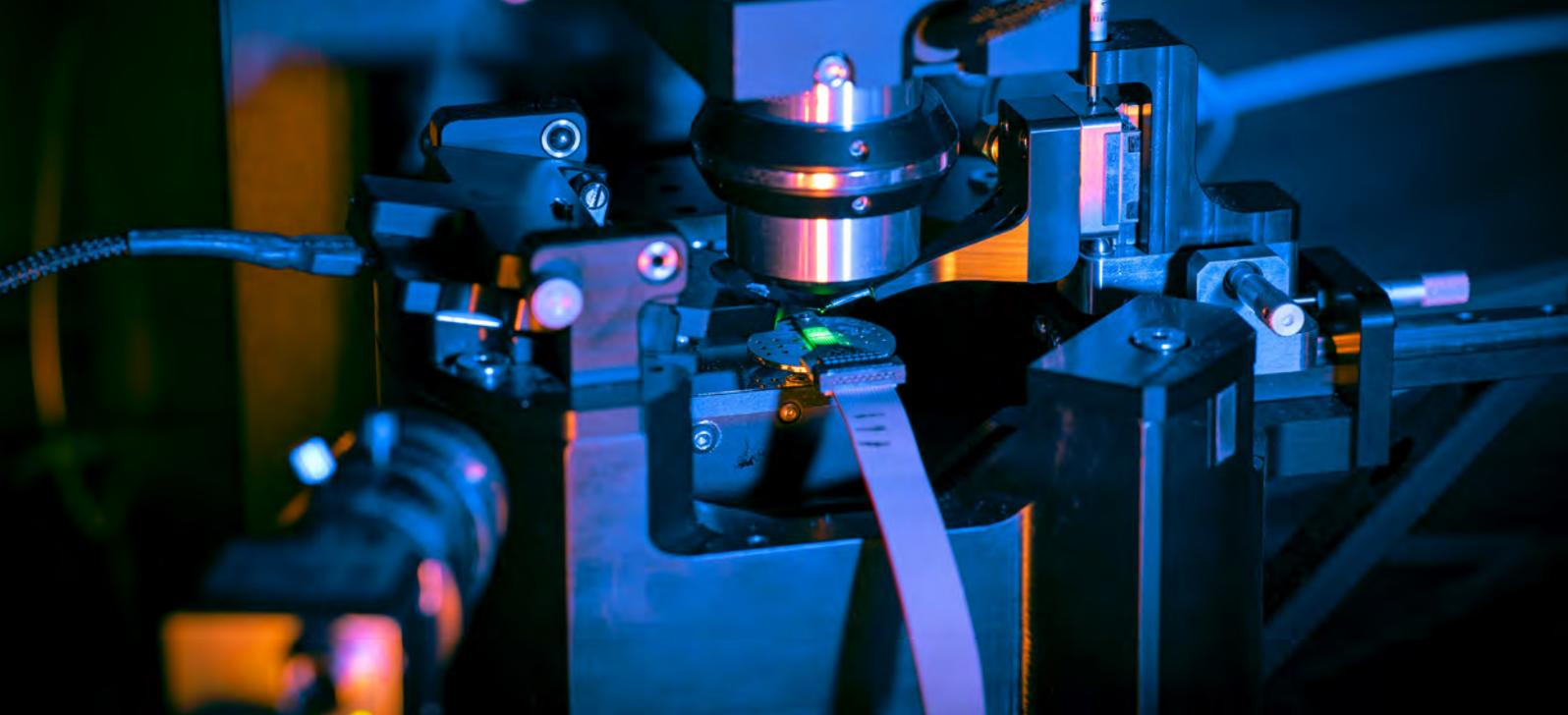
*Das hochempfindliche Rastersondenmagnetometer ProteusQ der Firma Qnami nutzt Diamantspitzen mit einem einzelnen NV-Zentrum für präzise Messungen*
