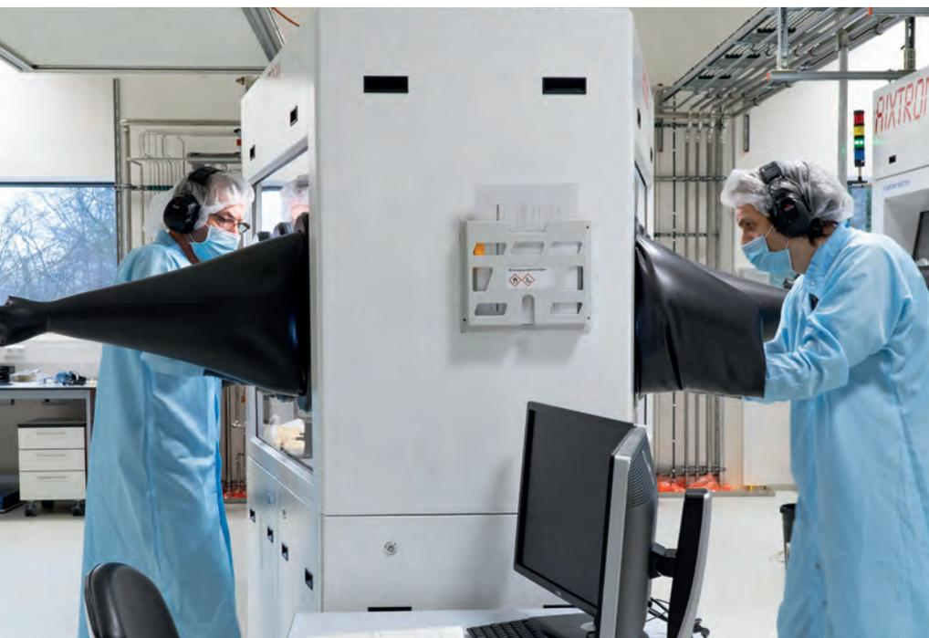
*Im Neubau wurde 2021 eine neue Anlage für (AlSc) N-haltige Materialien installiert, die Temperaturen von bis zu 1400°C erreicht, wodurch sich die Kristallqualität deutlich verbessert.*
